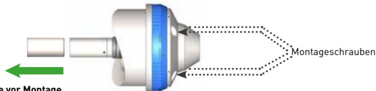
**ACHTUNG:** Druckstange vor Montage des Spannfutters nach hinten fahren.
