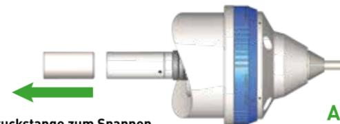
**ACHTUNG:** Druckstange zum Spannen des Einstellstiftes nach hinten fahren.
